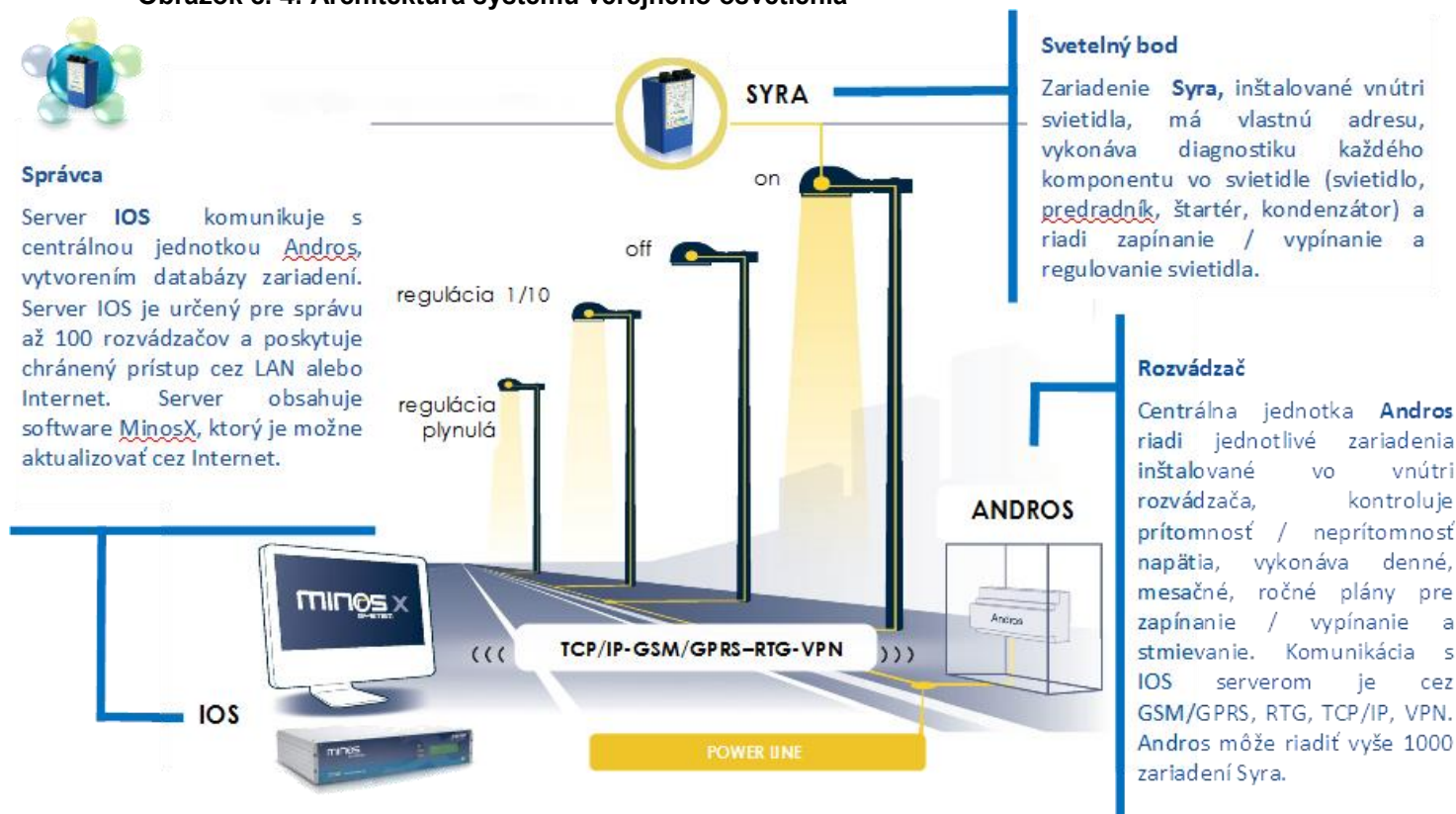
Obrázok č. 4: Architektúra systému verejného osvetlenia
